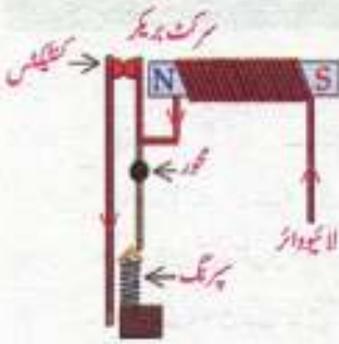
شکل 14.20: بریکر بریکر کے کام کرنے کا اصول
