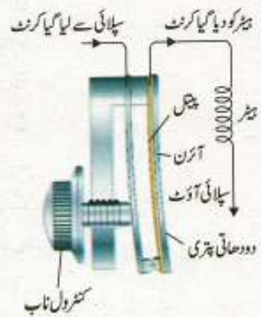
شکل 8.20: دو دھاتی تھرمو سٹیٹ پہلے سے سین کے ٹھنڈی ٹھنڈی پر الیکٹریک سرکٹ کو کات دیتا ہے۔
